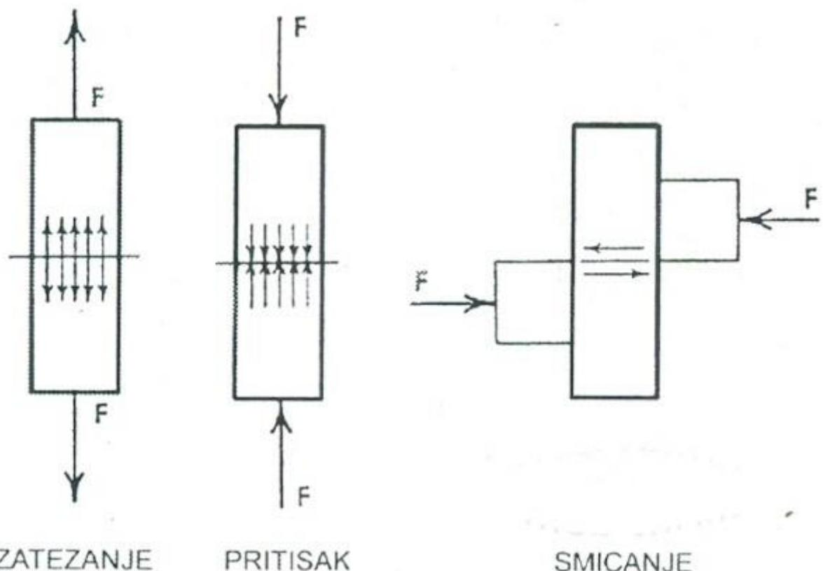
Slika 5. Naprezanja na mosnu konstrukciju.
