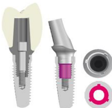
Slika 2. Cilindrični dosjed s antirotacijskim utorima. Preuzeto: (6)
