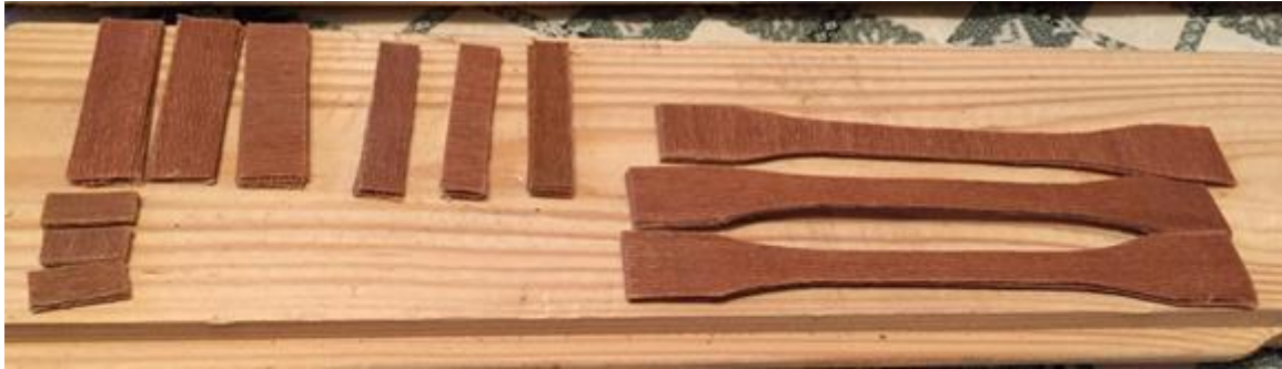
Sl. 3: ispitna tijela (epruvete) izrađena prema normama
