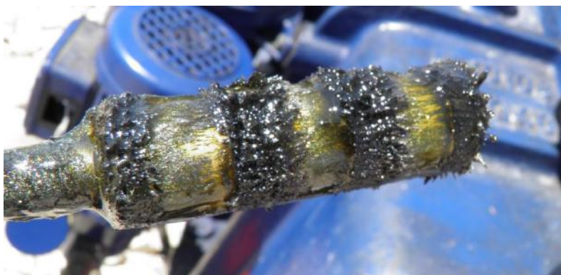
Slika 4. Nakupine metalnih čestica filtera ulja prijenosnika snage
