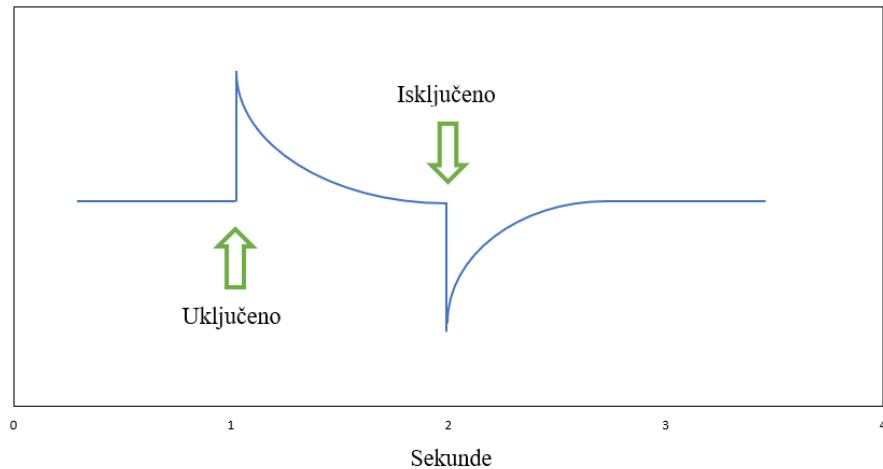
Slika 1. Piezoelektrični potencijal
