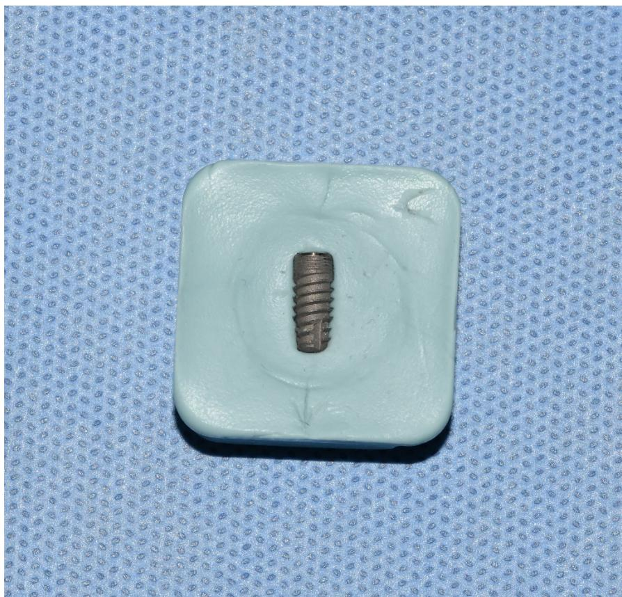
Slika 8. Implantat postavljen u sterilan silikonski držač kako bi se spriječilo okretanje i pomicanje tijekom dekontaminacije i uzimanja uzorka.
