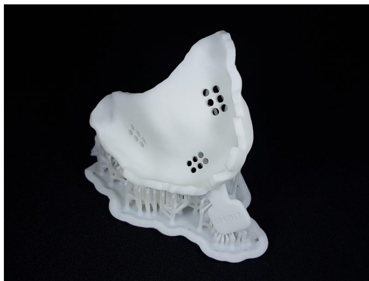
Slika 10. 3D printana individualna žlica potpornim elementima vezana za postolje.
