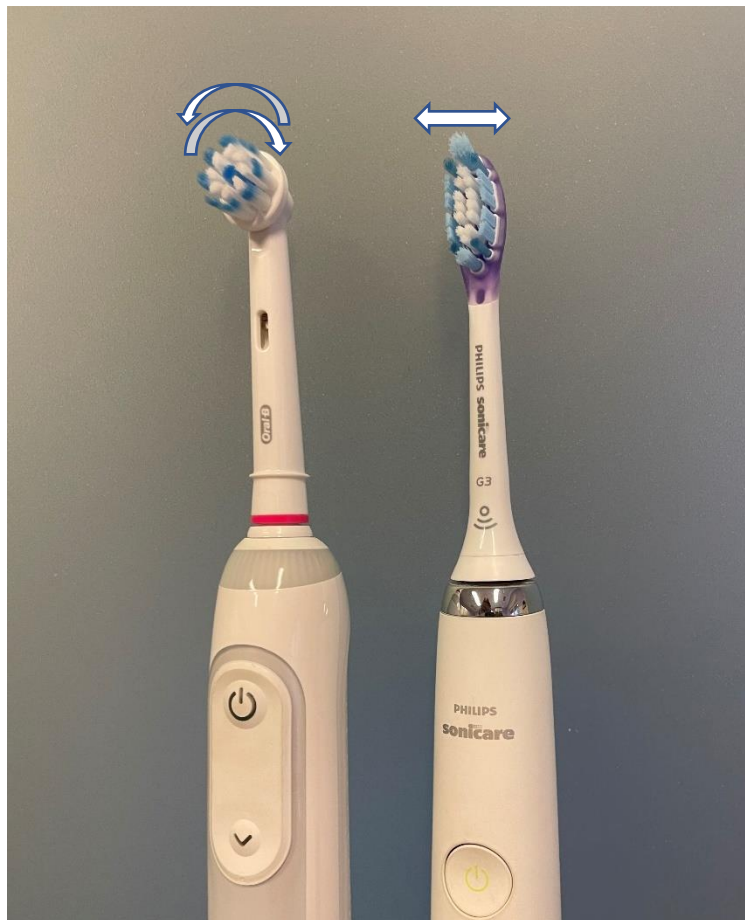
Slika 5. Oscilirajuće-vibrirajuća i vibrirajuća/zvučna električna zubna četkica
