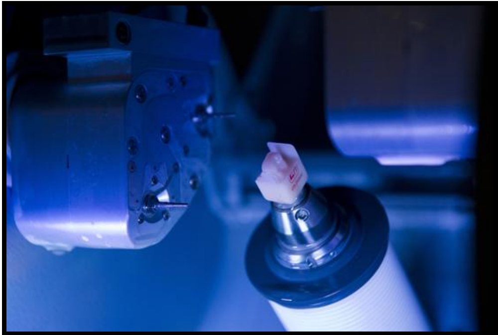
Slika 8. Računalno potpomognuta izrada (CAM) nadomjeska glodanjem keramičkoga bloka. Preuzeto iz: (21)
