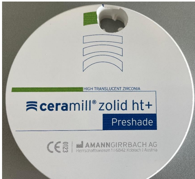
Slika 32. Blok materijala iz kojeg će se glodati osnovna konstrukcija.
