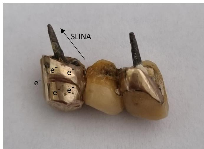
Slika 2. Proces elektrokemijske korozije u usnoj šupljini. U uvjetima usne šupljine, nadogradnja izrađena iz kobalt-krom legure se ponaša kao anoda, a krunica izrađena od zlata kao katoda, slina djeluje kao elektrolit.
