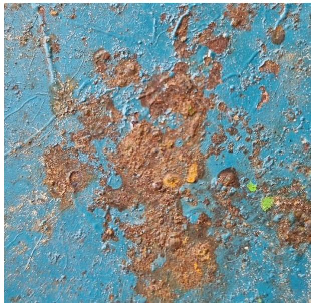
Slika 1. Taloženje površinskih oksida uslijed kemijiskog korodiranja metala.
