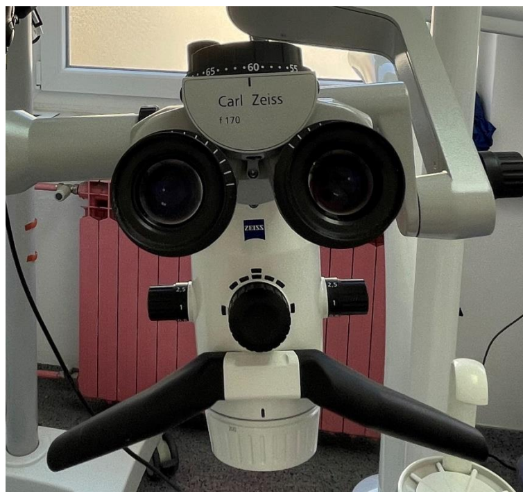
Slika 6. Oznaka fokalne udaljenosti leće tubusa (170 mm).
