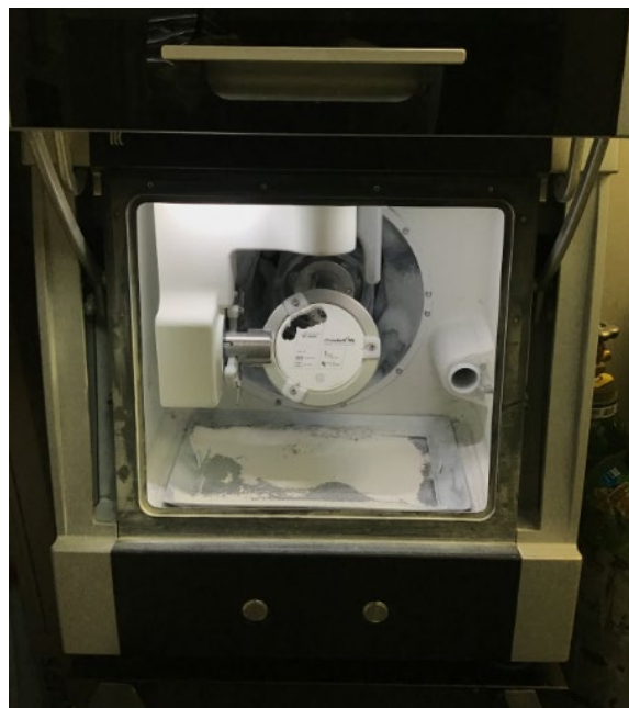
Slika 31. Stavljanje bloka u glodalicu
