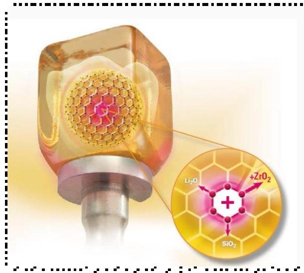
Slika 28. Shematski prikaz sastava litij-disilikatne staklokeramike ojačane cirkonij-dioksidom.
