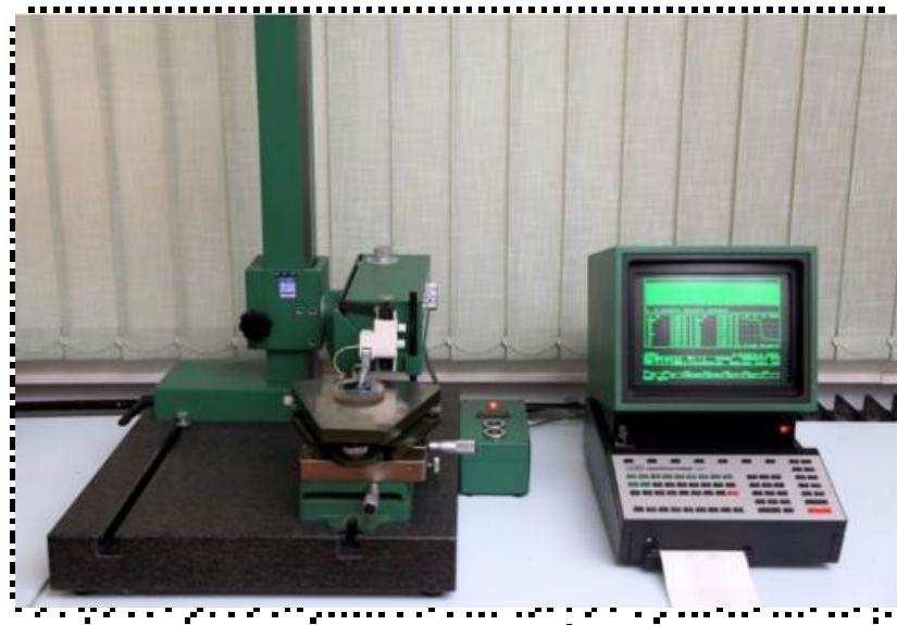
Slika 69. Uređaj za analizu hrapavosti Perthometer S8P.
