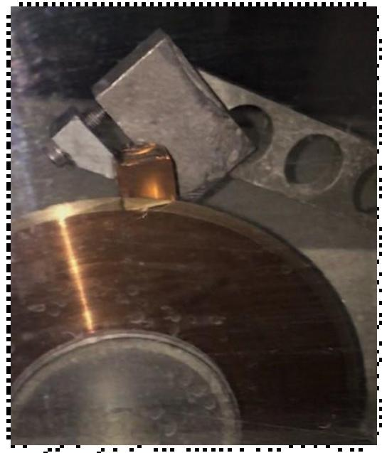
Slika 47. Postupak rezanja CAD/CAM bloka u prekristaliziranom stanju.
