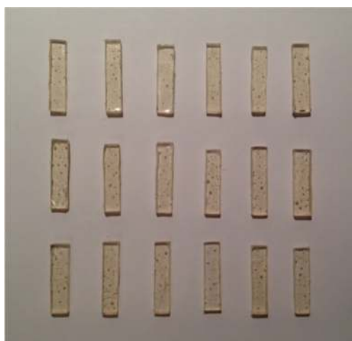
Slika 5. Uzorci PDLG 5010 pripremljeni za uranjanje.
