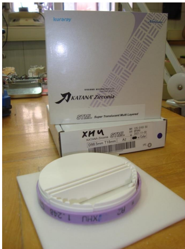
Slika 26. Blok STML, dimenzija D = 98.5 mm, T = 18 mm, boje A2 .
