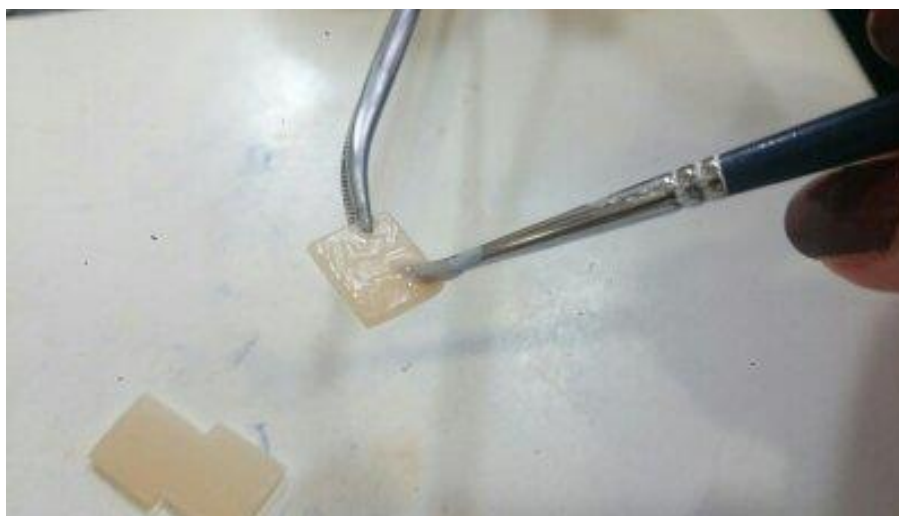
Slika 38. Nanošenje glazure na uzorak.
