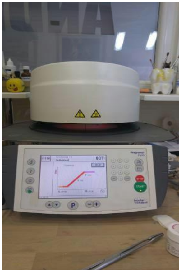
Slika 41. Napečenje glazure prema uputi proizvođača.
