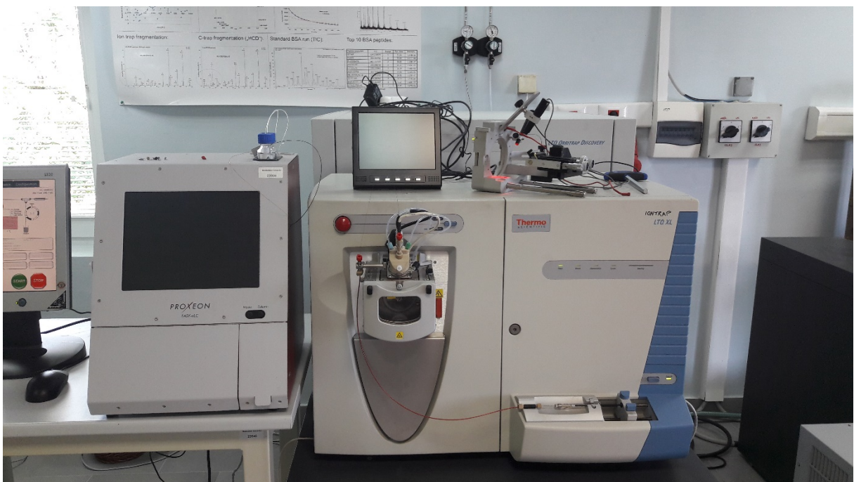
Slika 15. Tekućinska kromatografija i masena spektrometrija
