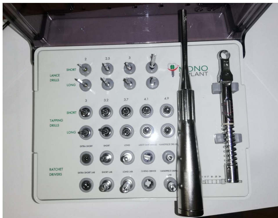
Slika 7. Instrumenti za izradu ležišta za jednodijelne dentalne implantate. Preuzeto s ljubaznošću dr. sc. Dine Bukovića, izv. prof.
