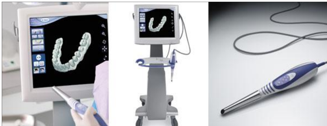
Slika 10. Lava COS intraoralni dentalni skener. Preuzeto iz: (21)
