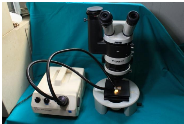
Slika 30. Uzorak nakon push-out testiranja na pregledu pod stereomikroskopom.
