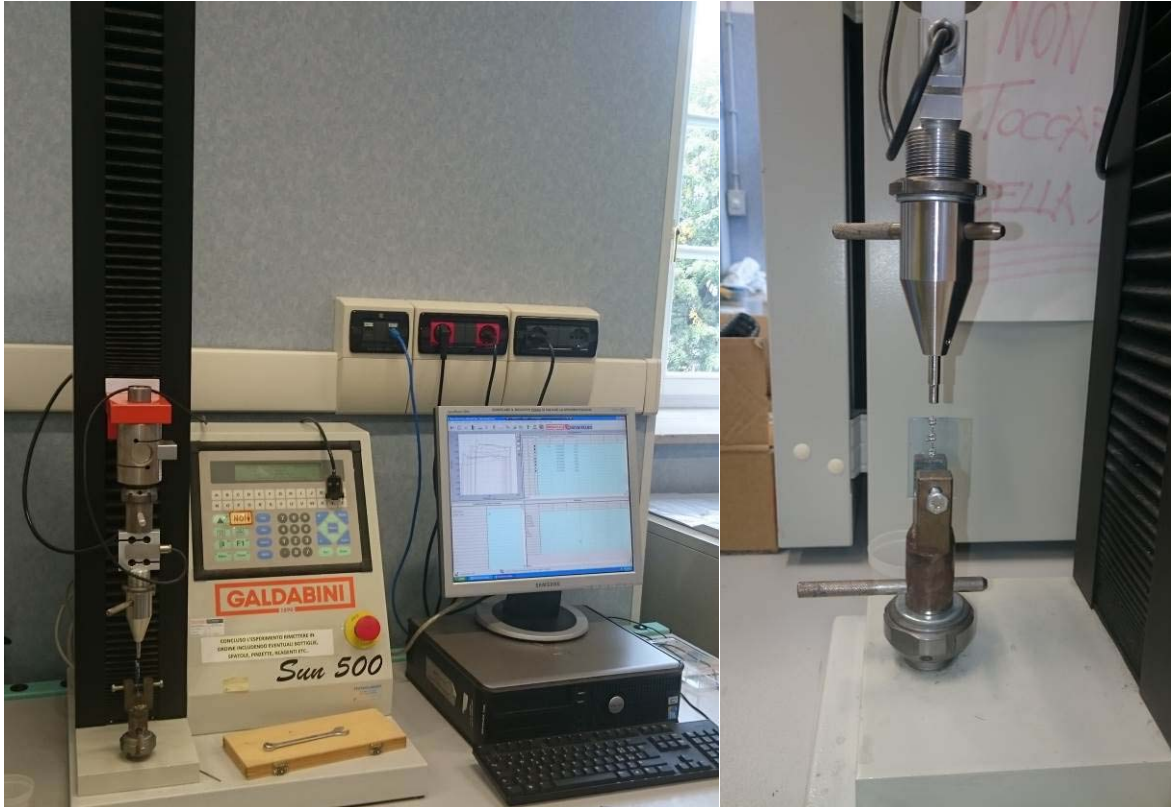
Slika 10. Mjerenje trenja univerzalnim strojem za ispitivanje materijala Sun 500 (Galdabini, Cardano al Campo, Italija)
