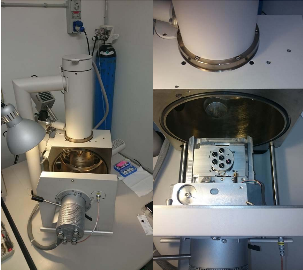
Slika 6. Pretražni elektronski mikroskop ( SEM FEI Quanta-200, FeI Company, Hillsboro, SAD )
