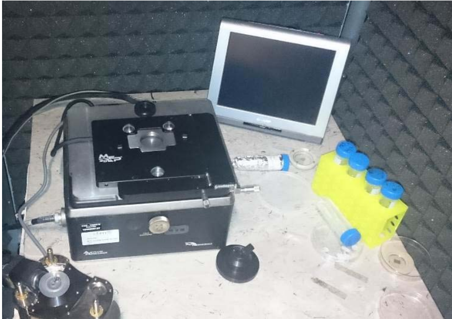
Slika 7. Mikroskop atomskih sila (AFM) NT-MDT Solver Pro AFM (NT-MDT, Moskva, Rusija)
