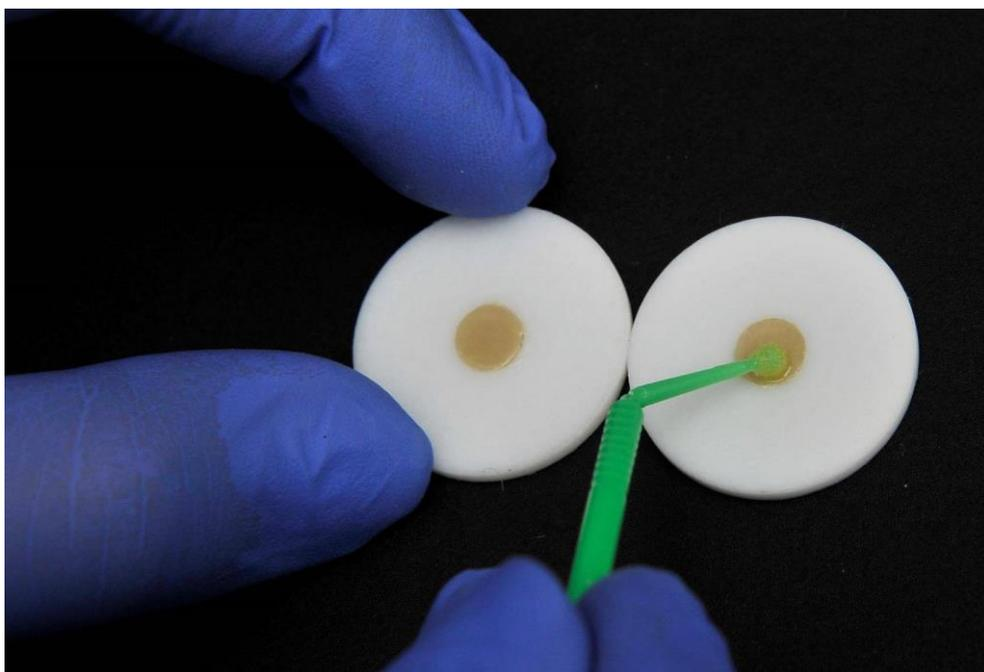
Slika 6. Premazivanje uzoraka EQUIA Forte HT-a EQUIA Forte Coatom
