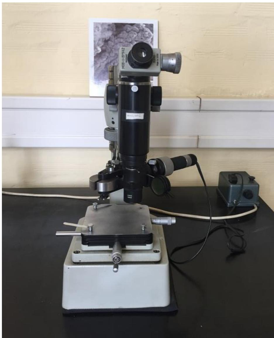
Slika 11. Uređaj za ispitivanje mikrotvrdoće po Vickersu
