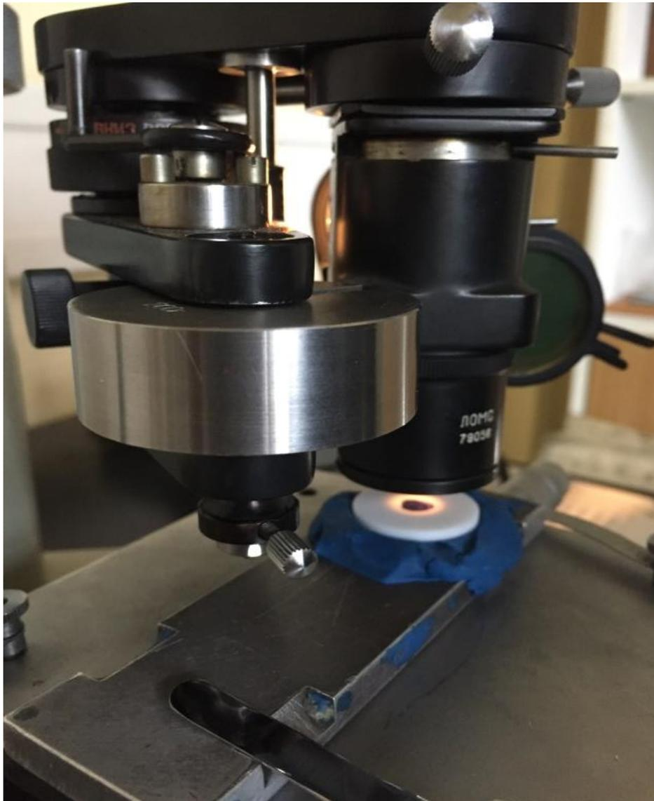
Slika 12. Ispitivanje mikrotvrdoće
