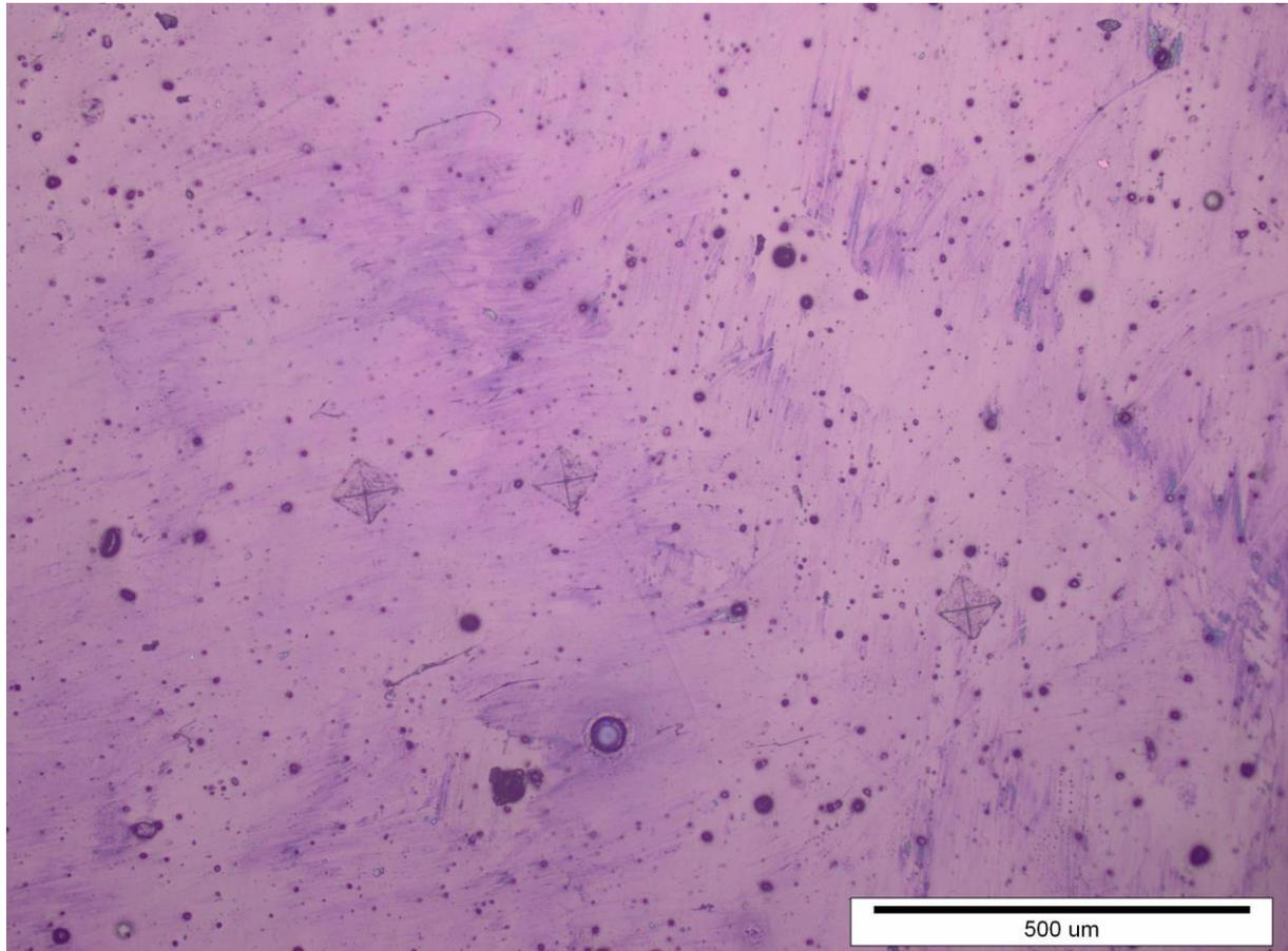
Slika 13. Otisci na površini uzorka
