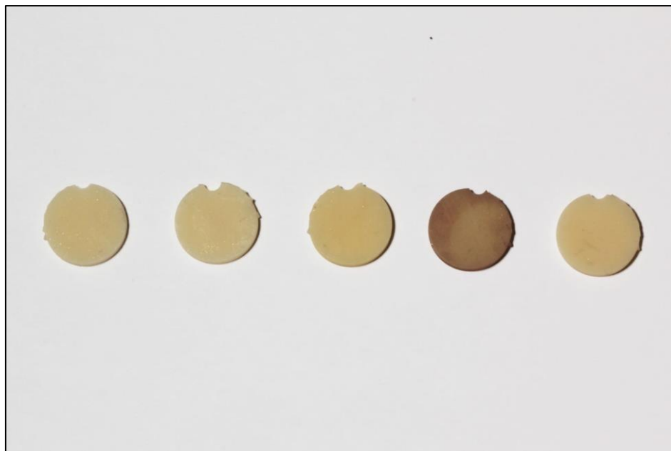
Slika 5. Uzorci od 3D printanog materijala Nextdent C&B (Nextdent, Soesterberg, Nizozemska) nakon 30 dana pohranjivanja u (s lijeva na desno): 1) destiliranoj vodi, 2) Coca-Coli, 3) kavi, 4) crnom vinu i 5) balzamičnom octu
