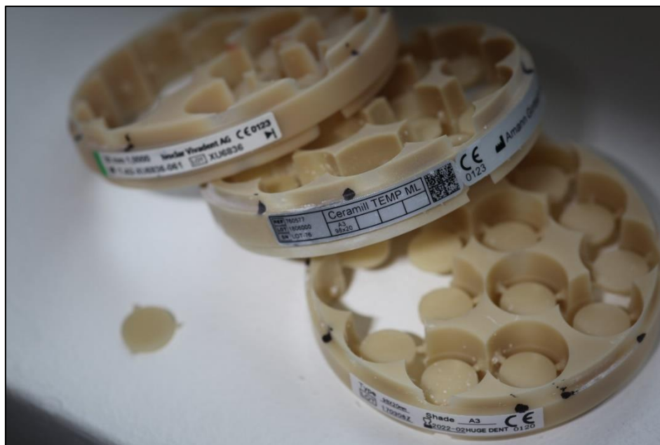
Slika 2. Uzorci izrađeni CAD/CAM tehnologijom neposredno nakon glodanja
