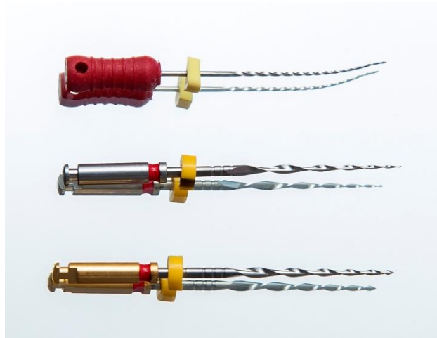
Slika 1. Usporedbe čeličnog (strugač #25) i NiTi (F360, F6 SkyTaper) instrumenta nakon savijanja
