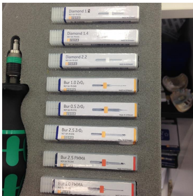
Slika 7. Svrkla za glodalicu. Preuzeto s dopuštenjem autora: doc. dr. sc. Andreja Carek.
