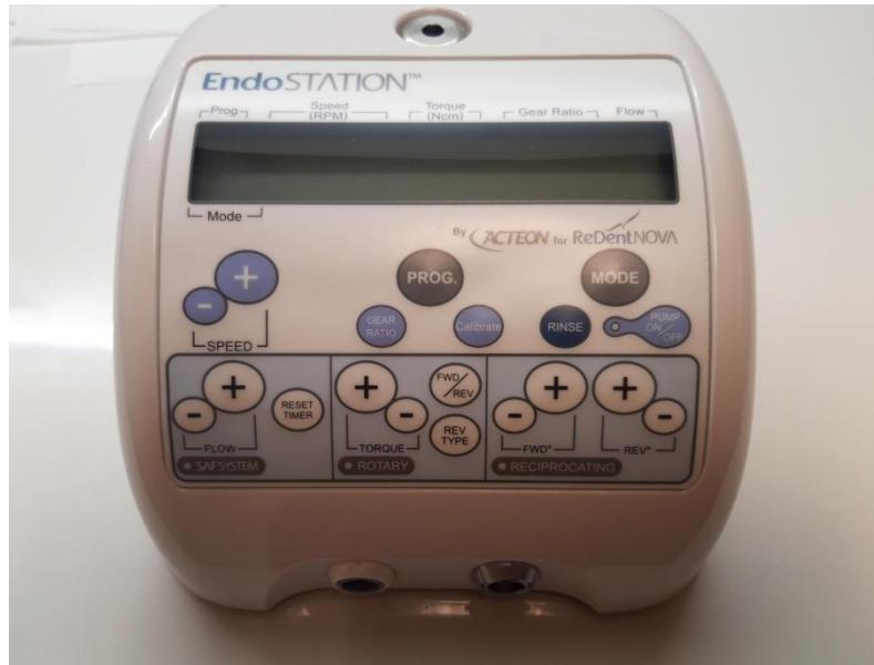
Slika 9. EndoSTATION - stroj za SAF metodu dezinfekcije uz podržane reciprocirajuće i rotirajuće tehnike instrumentacije
