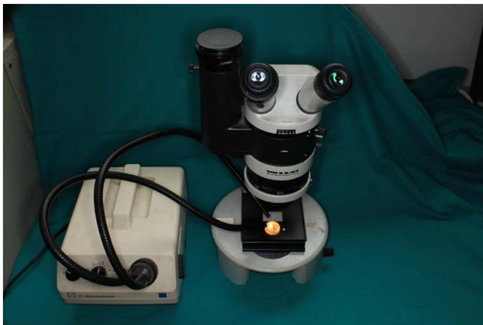
Slika 14. Određivanje količine zaostatnog cementa stereomikroskopom ( Wild Heerbrugg)
