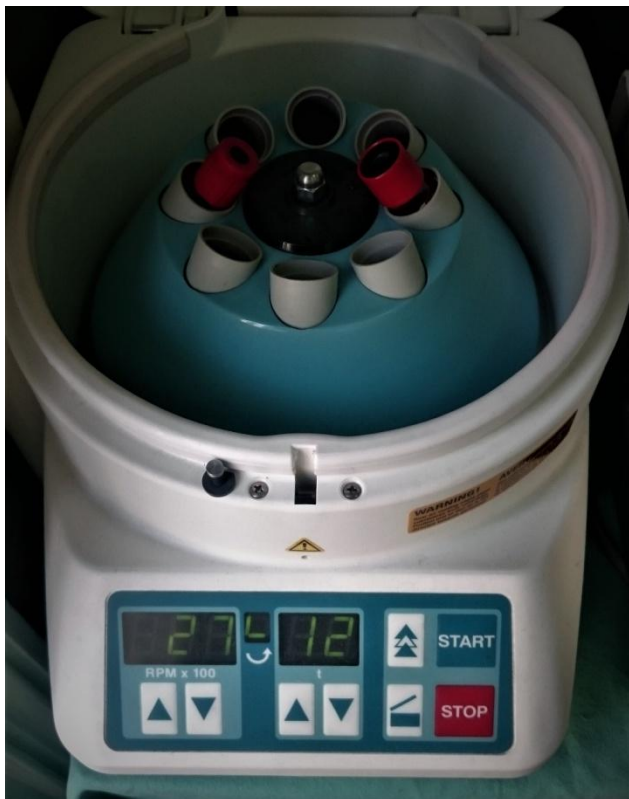
Slika 1. Postavljanje dviju epruveta s venskom krvi u centrifugu (12 minuta, 2700 rpm). Preuzeto s dopuštenjem autora doc.dr.sc.Ivana Puhara.
