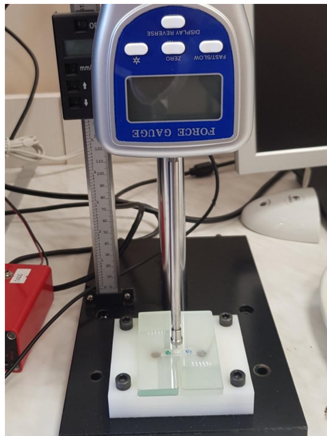
Slika 10. Univerzalni uređaj za push out test
