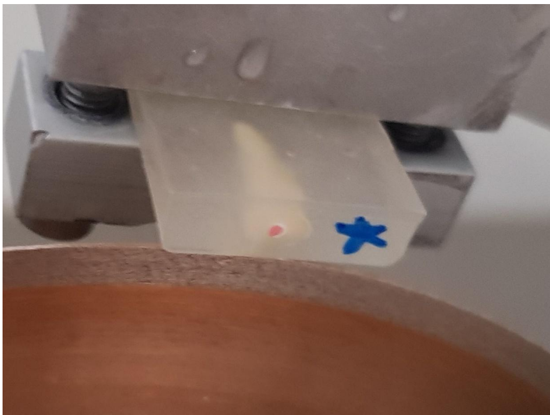
Slika 9. Rezanje uzoraka korijena zuba na Isomet pili
