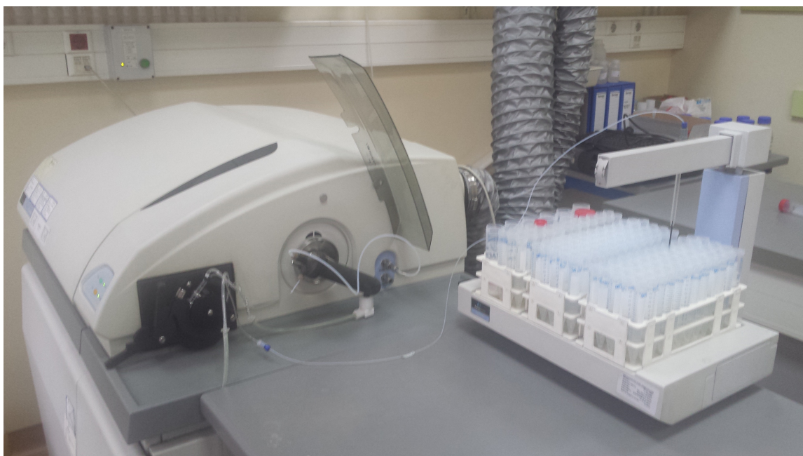
Slika 17. Sustav za automatsko uzorkovanje otopine za kemijsku analizu na masenom spektrometru induktivno spregnutom plazmom, Elan 9000, "PerkinElmer", Waltham, SAD, u Glavnom vodnogospodarskom laboratoriju, Hrvatske Vode d.d., Zagreb, Hrvatska.
