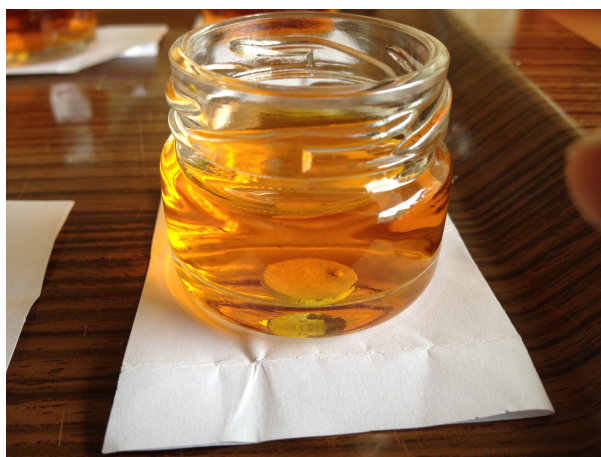
Slika 14. Uzorak uronjen u ispitivanu otopinu tijekom statičkog testa uranjanja s periodičnom analizom prema zahtjevima norme ISO 10271:2011 (116).
