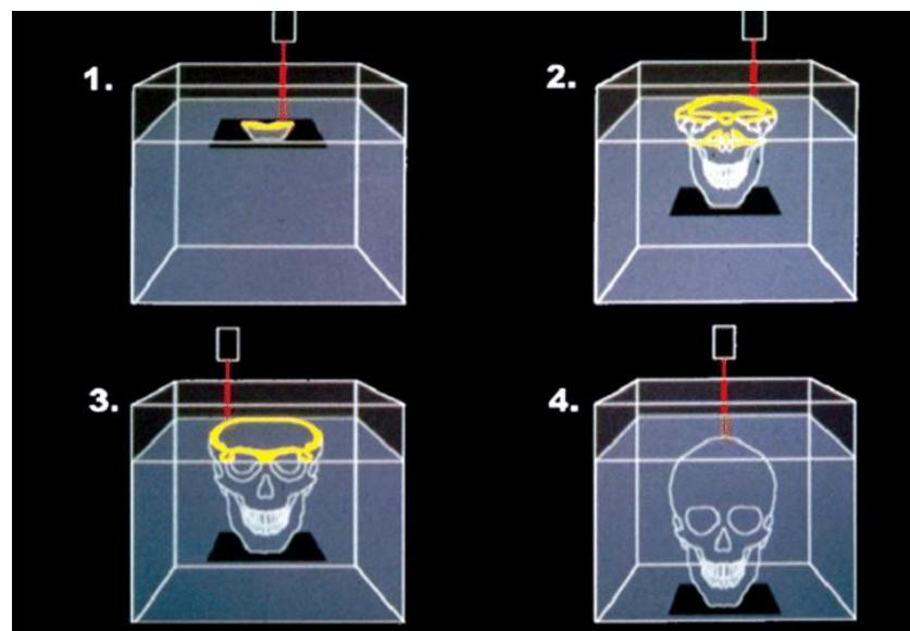
**Slika 9.** Princip stereolitografije. Preuzeto s dopuštenjem izdavača: (15).
