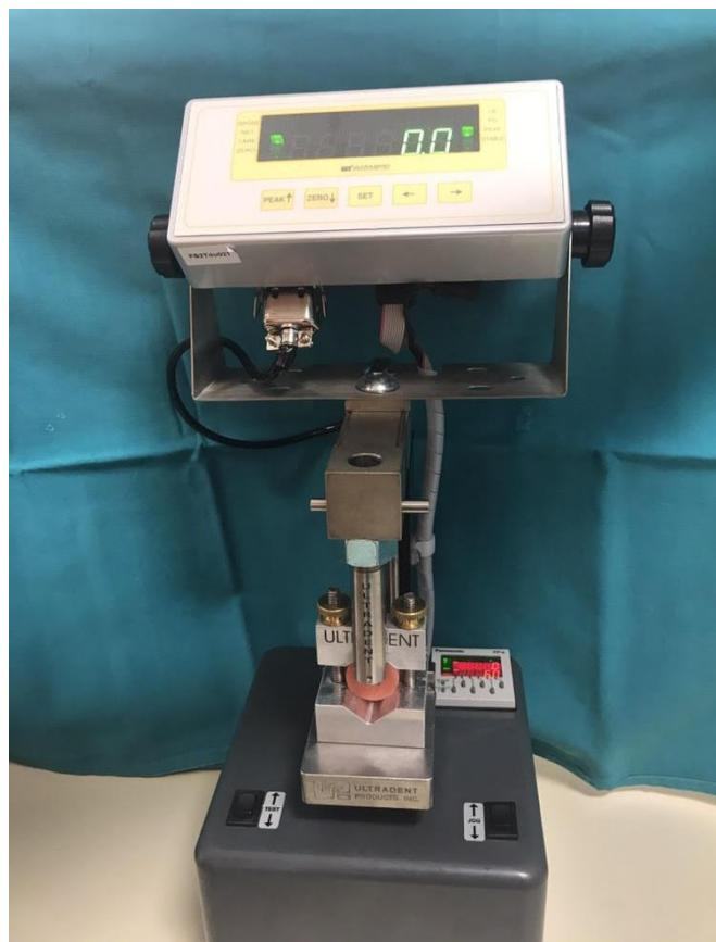
**Slika 9.** Uređaj za mjerjenje jačine adhezijske sveze (UltraTester, Bond Strength Testing Machine, Ultradent Products, Inc., South Jordan, UT, USA)
