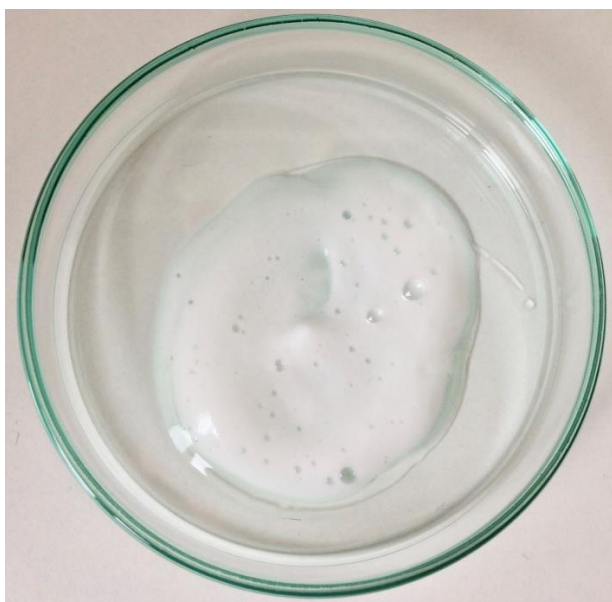
Slika 6. Reakcija lubrikansa s NaOCl-om
