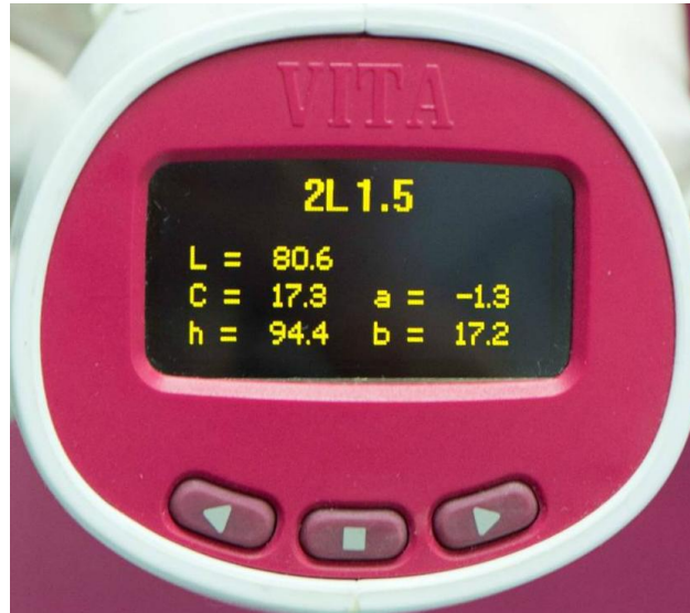
Slika 11. Spektrofotometrom dobivene vrijednosti L*, C*, h, a* i b* prije izbjeljivanja.
