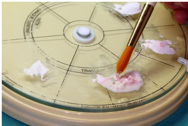
Slika 56. Ručno mješanje keramičkoga materijala
