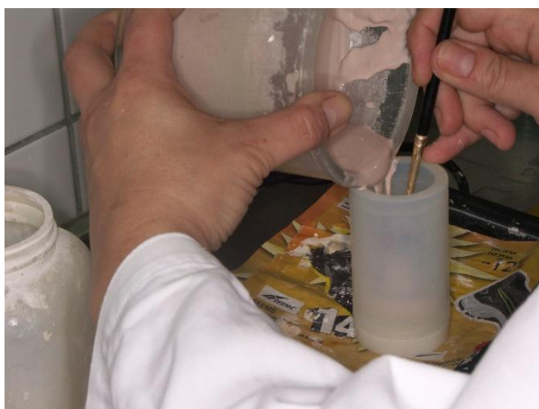
Slika 59. Silikonska kiveta i postupak ulaganja
