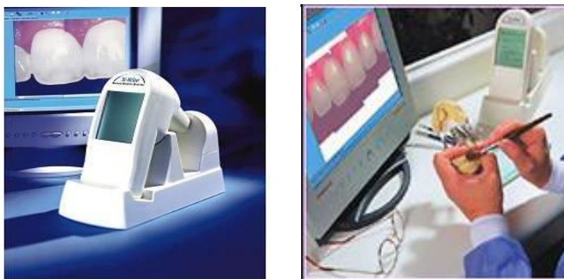
Slika 44. Shade Vision kolorimetar (X-Rite,Grandville,SAD ) (preuzeto iz 169)
