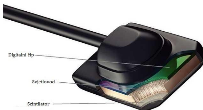
SLIKA 3. Grada intraoralnoga digitalnog senzora (preuzeto iz 38)
