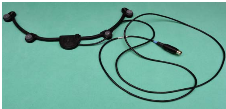
Slika 29. Donji luk mjernog uređaja (transmiteri).
