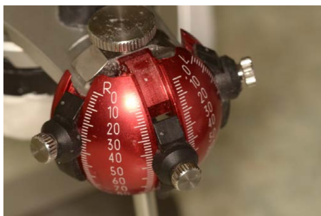
Slika 21. Podešavanje kuta incizijskog vođenja (KIV) i kuta lateralnog prednjeg vođenja (KLV) na artikulatoru.
