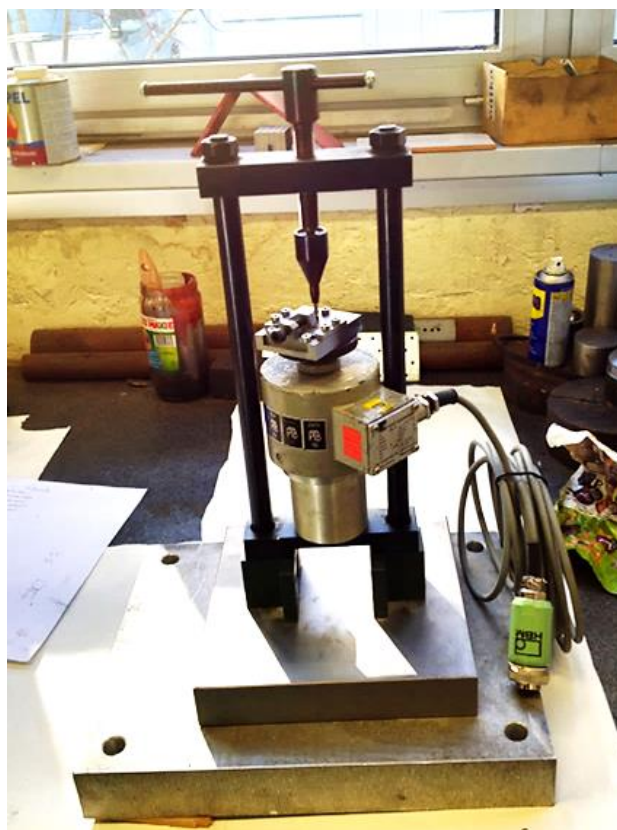
Slika 5. Pozicioniranje fiksacijske naprave na dinamometarskom stoliću
