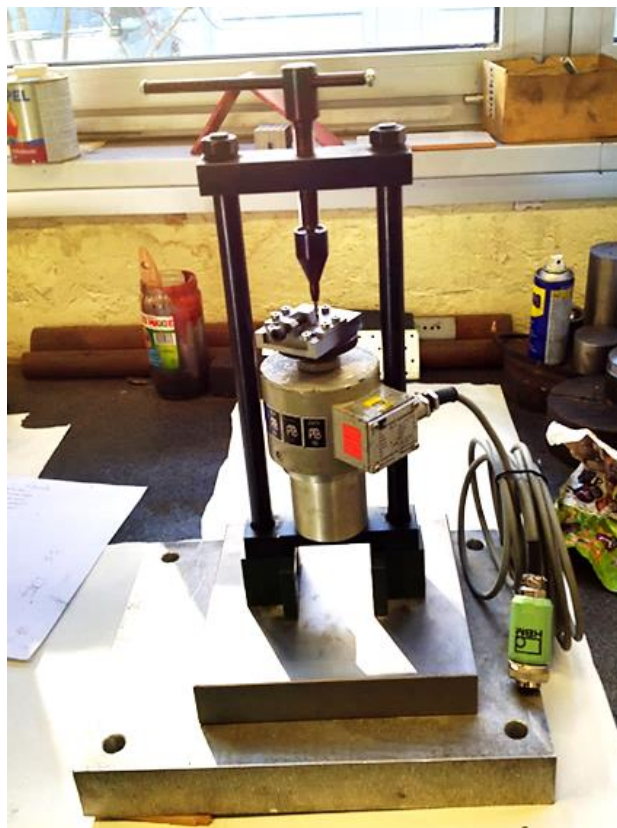
Slika 5. Pozicioniranje fiksacijske naprave na dinamometarskom stoliću
