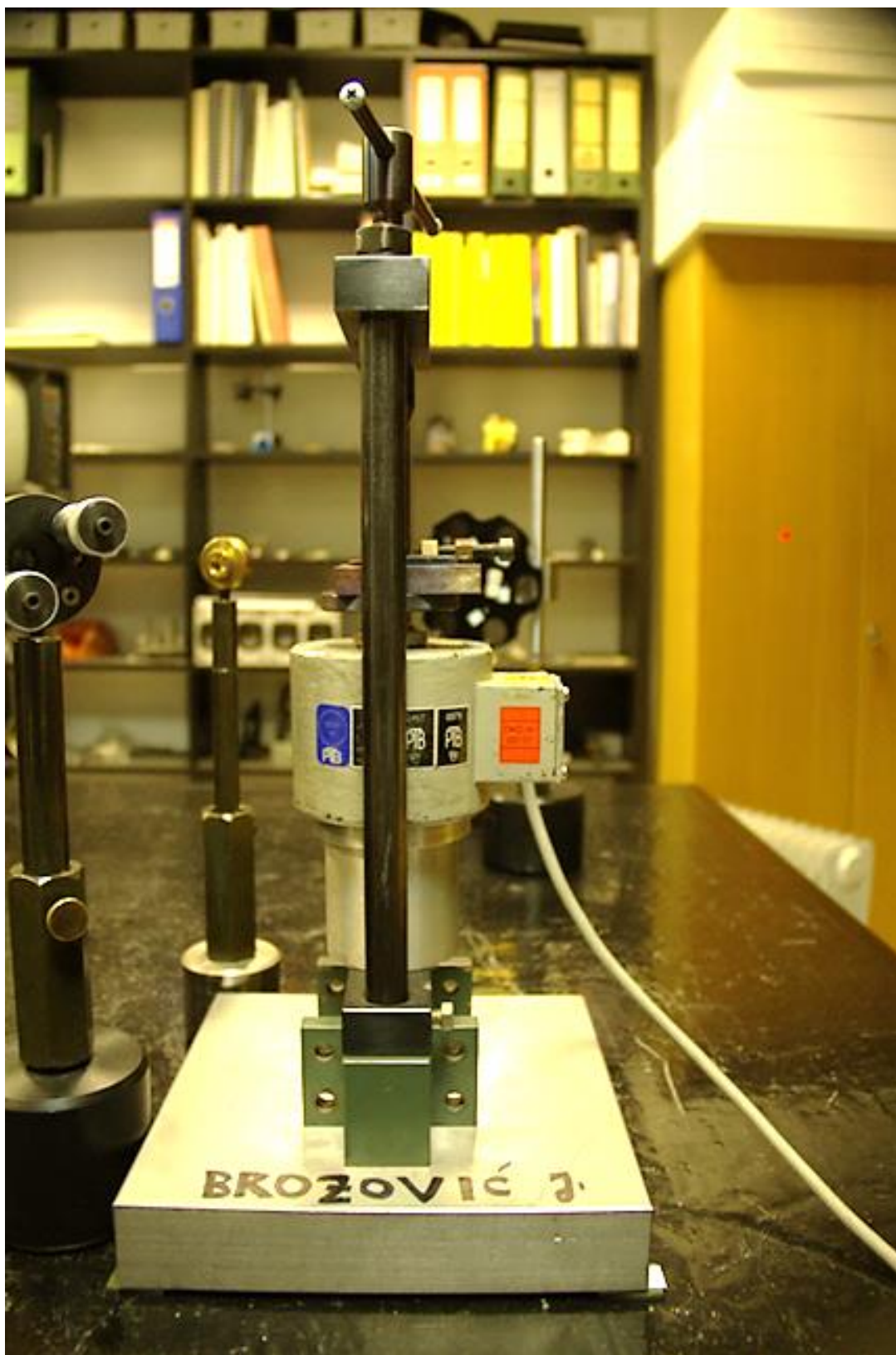
Slika 13. Uređaj za opterećenje implantata u funkciji
