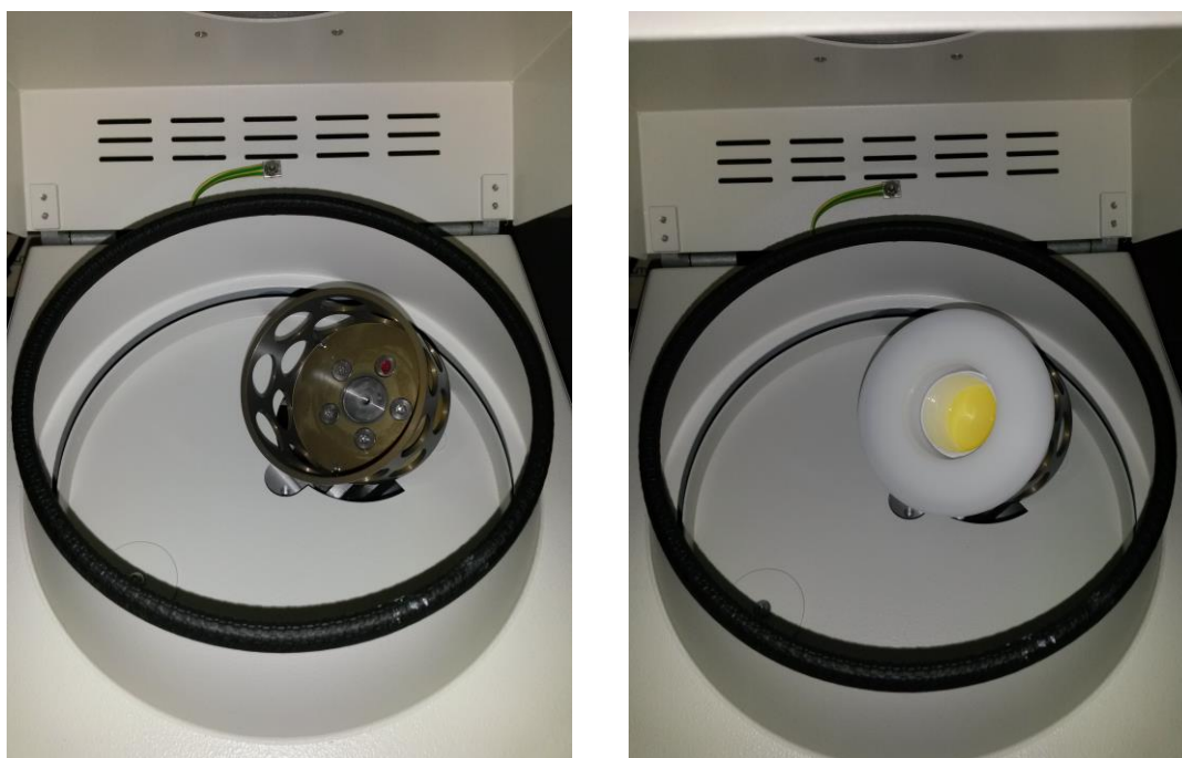
Slika 3. Unutrašnjost centrifugalne miješalice s držačem za miješanje kompozitnog materijala (lijevo) i postavljenom čašicom sa zamiješanim materijalom (desno).
