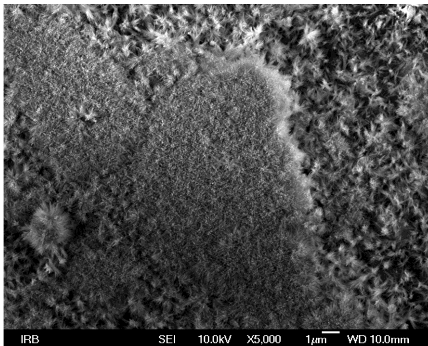
Slika 27. SEM snimka površine eksperimentalnog kompozitnog materijala C-40 nakon tri mjeseca imerzije u puferiranoj fiziološkoj otopini.
