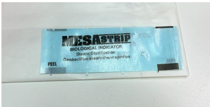
Slika 26. Spore za biološku kontrolu sterilizacije ( Geobacillus stearothermophilus ).
