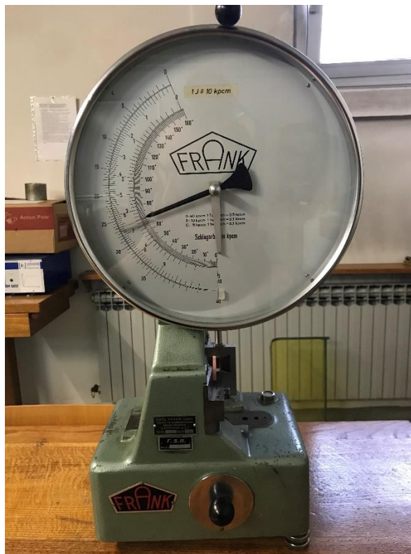
Slika 10. Charpyjev udarni stroj upotrijebljen za ispitivanje udarnog rada loma uzoraka.
