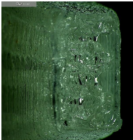
Slika 42. Makrostruktura ravnine loma uzoraka iz orijentacije 3 (uspravne).
