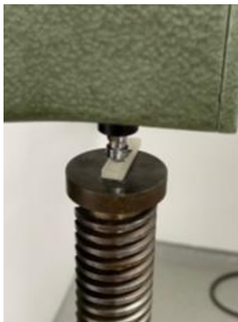
Slika 11. Ispitivanje tvrdoće uzorka od polilaktične kiseline (PLA).
