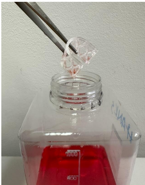
Slika 31. Model individualizirane biorazgradive augmentacijske mrežice (IBAM-a) izvađen iz Hankove izbalansirane otopine.
