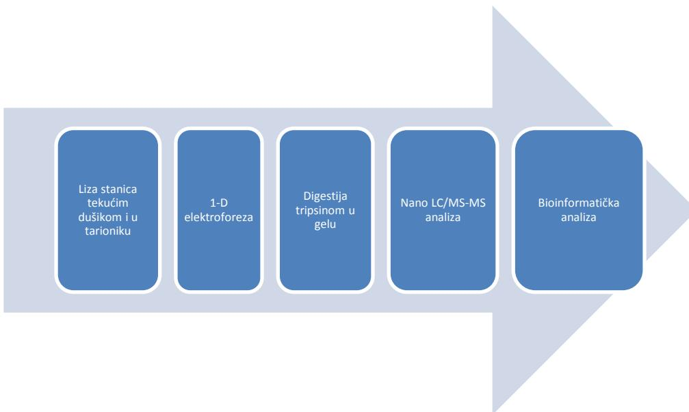
**Slika 3.** Tijek eksperimentalnih postupaka. Uzorci odloženi u tekući dušik su lizirani, proteini iz lizata su odvojeni 1-D elektroforezom te je nakon toga uslijedila digestija proteina u gelu tripsinom. Peptidi su nakon toga analizirani LC-MS/MS nakon čega su bioinformatički obradeni.
