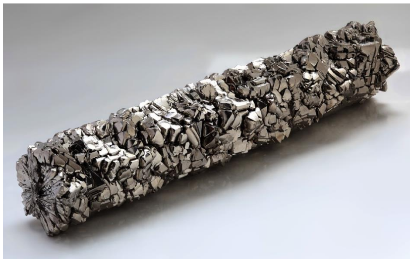
Slika 14. Šipka kristaliziranog titana, visoke čistoće 99.995 % (preuzeto iz 78)
