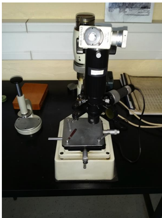
Slika 33. Ispitivanje tvrdoće po Vickersu
