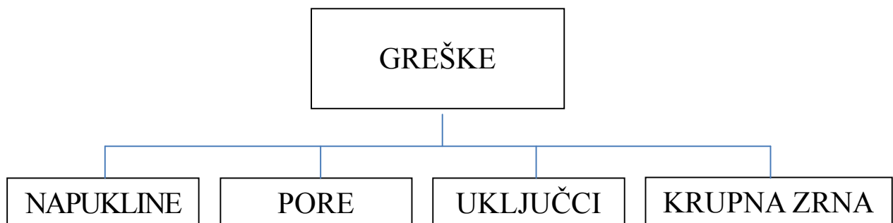
Slika 2. Greške u keramičkom materijalu. Preuzeto iz (22).
