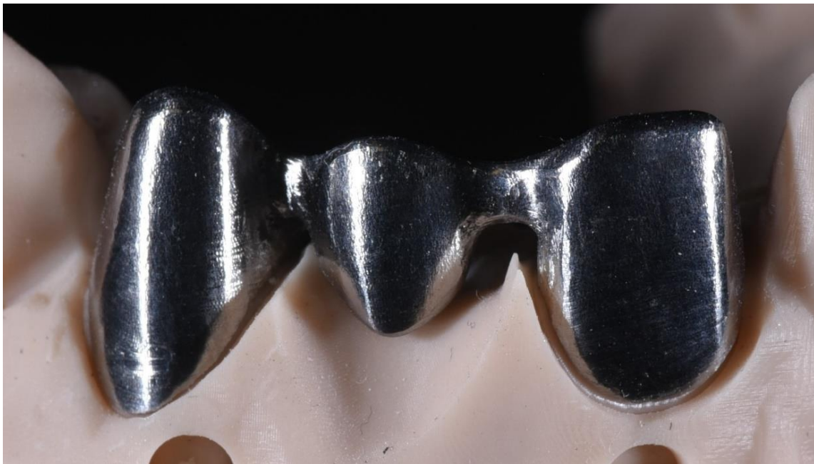
Slika 13. Osnova konstrukcija mosta izrađena aditivnom tehnologijom
