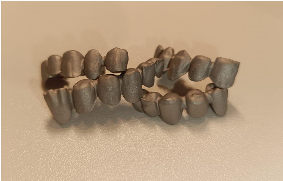
Slika 10. Glodane osnovne konstrukcije fiksoprotetskih nadomjestaka iz Co-Cr legure
