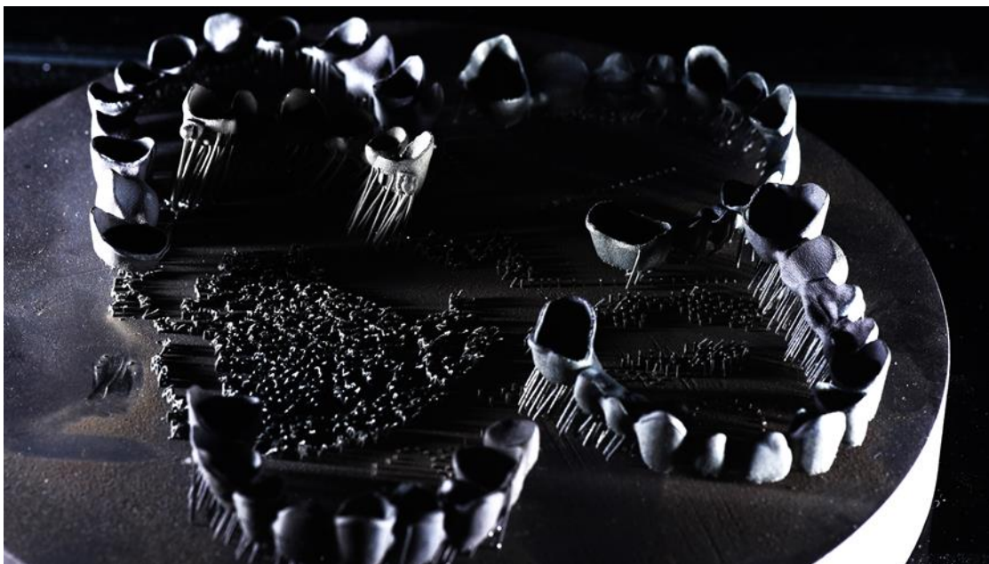
Slika 12. 3D građene metalne konstrukcije fiksnoprotetskih nadomjestaka
