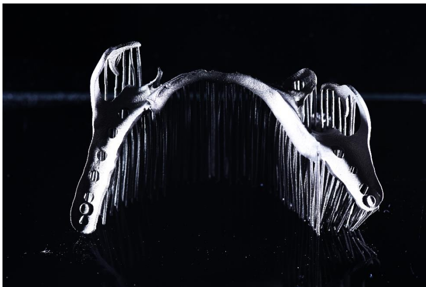
Slika 15. 3D građena osnova donje djelomične proteze
