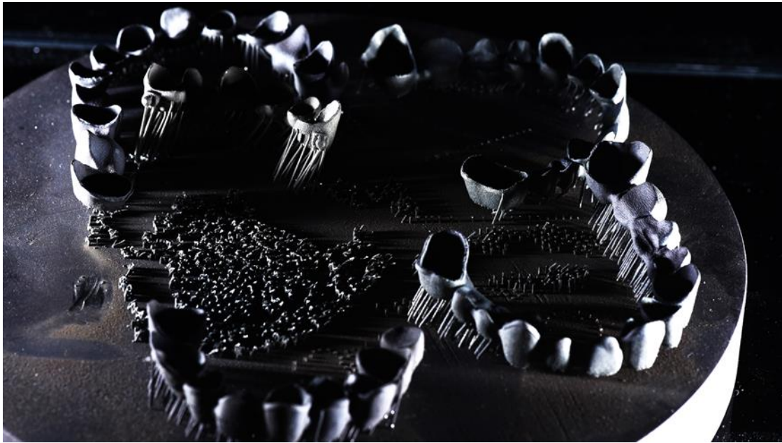
Slika 12. 3D građene metalne konstrukcije fiksnoprotetskih nadomjestaka
