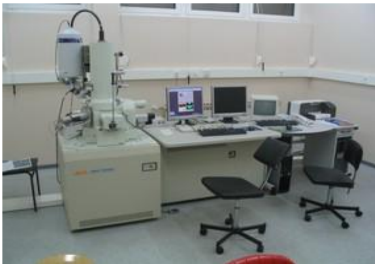
Slika 25. Pretražni elektronski mikroskop JSM 7000F (JEOL, Japan) sa spektroskopom karakterističnog X-zračenja INCA-350 (Oxford Instruments, Engleska).
