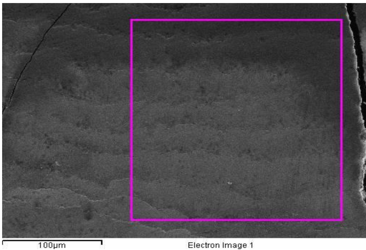
Slika 86. EDS analiza površine cakline.
