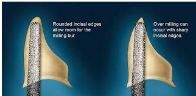
Slika 6. Brušenje za CAD/CAM izradu nadomjestka. Preuzeto iz 25.
