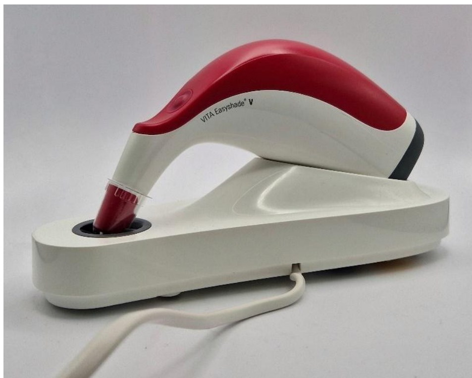
Slika 2. Spektrofotometar VITA EasyShade V.
