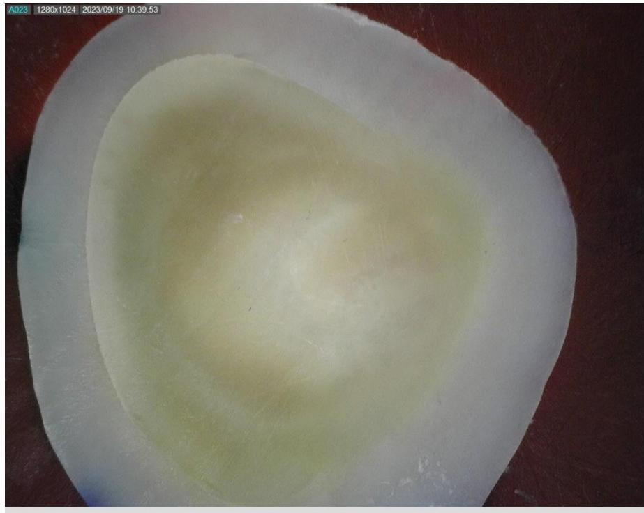
**Slika 38.** Slika uzorka s adhezijskom frakturom pod digitalnim mikroskopom *Dino-Lite*.
