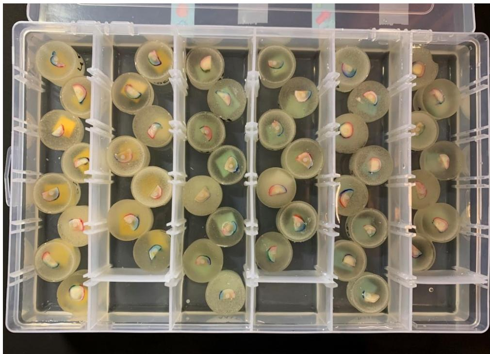
Slika 17. Uzorci pohranjeni u destiliranoj vodi.
