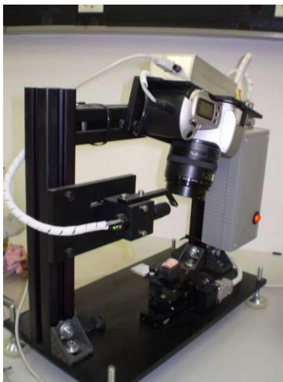
Slika 11. Uređaj za digitalnu lasersku profilometriju. Uređaj se sastoji od laserskog projektor-a, digitalne kamere s pomičnim stolićem i računalne jedinice (Ljubaznošću izv. prof. Dragane Gabrić).
