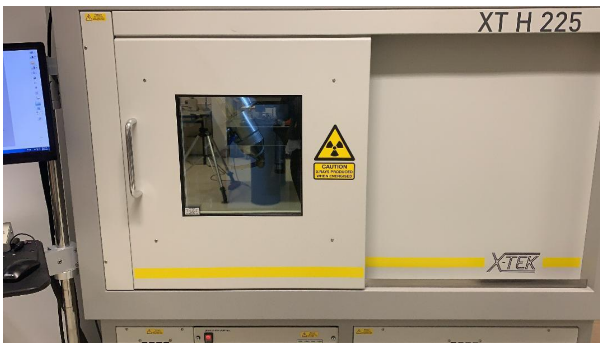
Slika 18. Industrijski mikro-CT (Nikon XT H 225) uređaj
