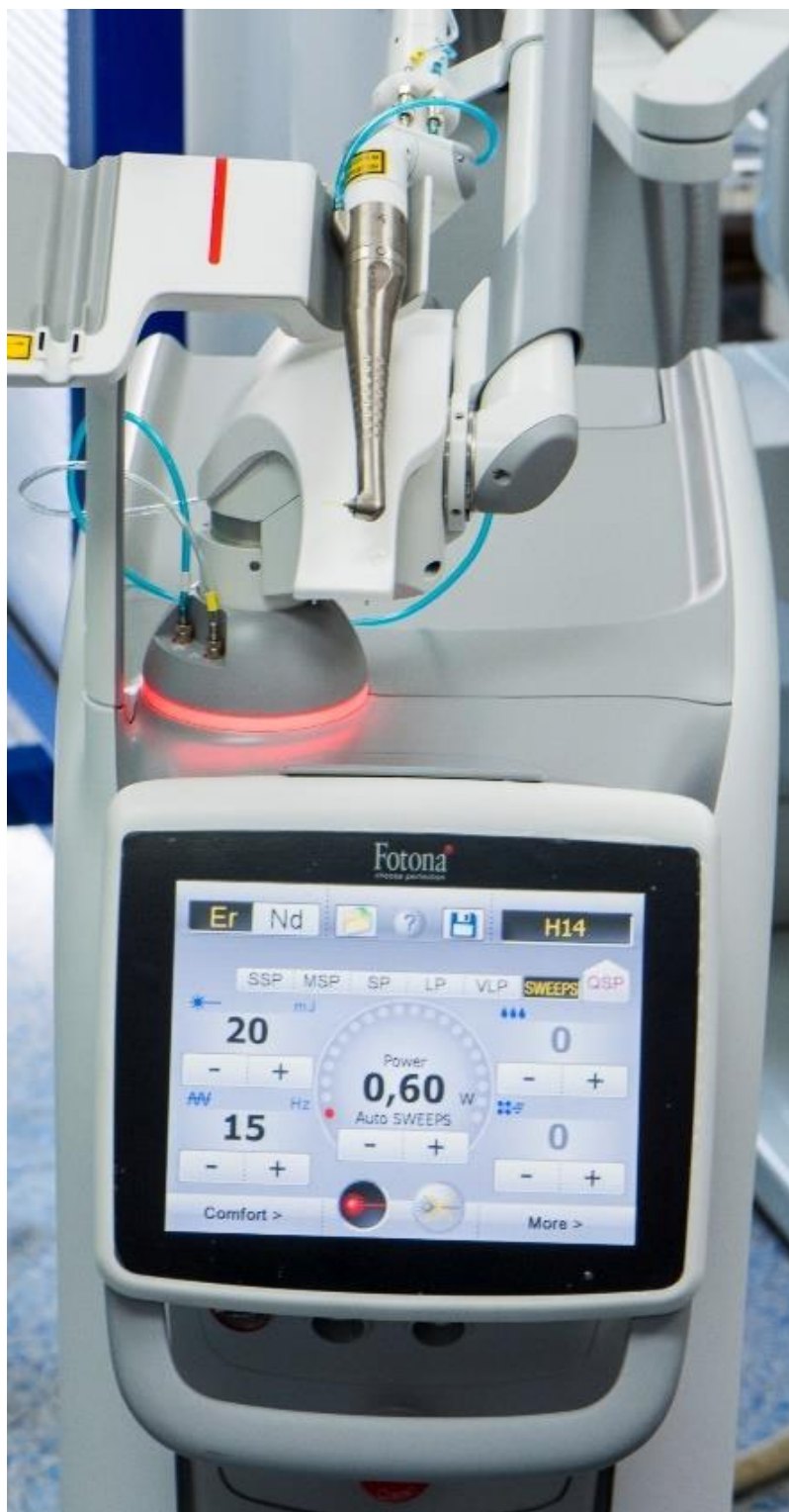
Slika 3. Er:YAG laser pripremljen za dezinfekciju endodontskog prostora
