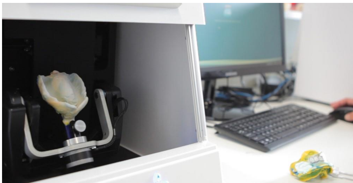
Slika 11. Postupak laboratorijskog skeniranja funkcijskog otiska i zagriznih šablona.
